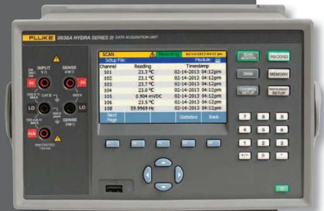
Mit DC-Messgenauigkeit von 0,0024 %, Thermoelement-Grundgenauigkeit von 0,5 °C, Farbbildschirm, bedienerfreundlichem Menüsystem und Sicherheitspezifikationen für industrielle Anwendungen ist das 2638A eine Klasse für sich unter den hochgenauen Messdatenerfassungssystemen. Die Messfunktionen im Multimeter-Modus mit 6,5-stelliger Auflösung bieten zusätzliche Funktionalität und Nutzen.
