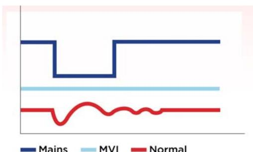
Eine instabile Spannungsversorgung ist die Hauptursache für Kalibrierungsungenauigkeiten vor Ort. In der Produktionsumgebung, in der große Elektromotoren, Heizelemente und andere Geräte periodisch ein- oder ausgeschaltet werden, werden herkömmliche Temperaturkalibratoren oft instabil. Die zyklischen Schwankungen der Spannungsversorgung können Unregelmäßigkeiten der Funktion des Temperaturreglers verursachen wie z.B. ungenaue Messungen und instabile Temperaturen.
