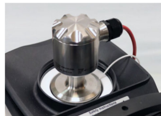
STS-102 A 035 Sensor und Sanitärsensor in einem Einsatz, montiert in einem RTC-168 Kalibrator.
