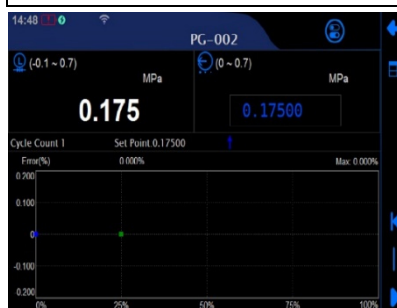
Manometer-/ Transmitter-/ Schalterkalibrierung
